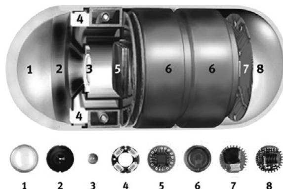
図2 カプセル内視鏡の構造
