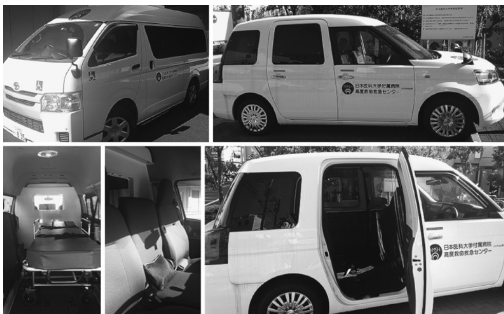
図8 日本医科大学付属病院で準備した陰圧車両 左：ストレッチャー型、右：タクシー型
