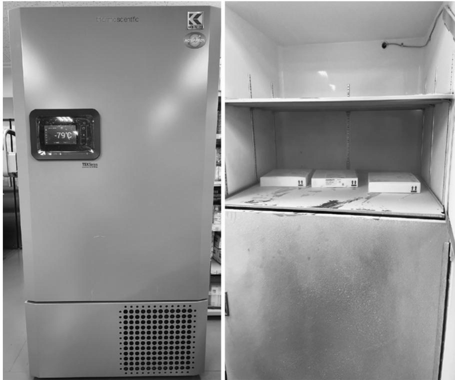
図1 コミナティ® 筋注保管用のディープフリーザー
