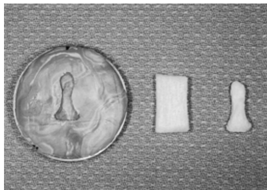
図3 PGA/PLLA ポリマーの作成 末節骨の鋳型(左)の中に, PLLA 溶液に浸したPGA ポリマー(中央)を挿入する。でき上がったPGA/PLLA ポリマーを乾燥させて, 末節骨の3次元形態をもつポリマー(右)を作成する。
