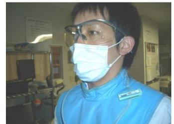
●頭部用ガラスバッジは防護エプロンの外。防護ができない皮膚線量測定をする
