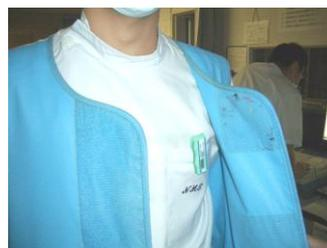
●胸部用ガラスバッジは防護エプロンの中。エプロンを透過した線量を測定
