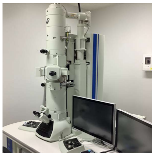
日本電子 JEM-1400Plus 設置年：2016年3月 設置場所：大学院棟地下1階 B1C01 機器別使用規約 ( PDF )
