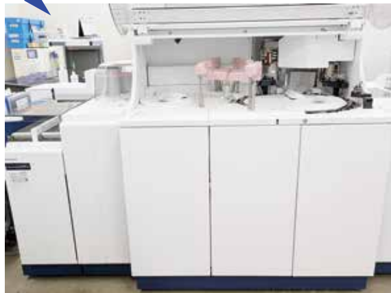
当院使用の生化学分析機器 処理能力2,000テスト/時間
